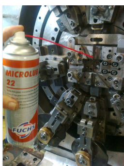
Lubrification de coulisseaux de guidage
